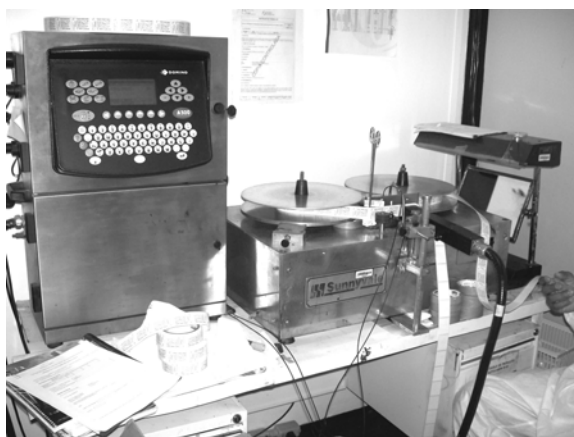
Figura 14 – Fotografia do equipamento de impressão de rótulos (OLIVEIRA et al , 2008)
