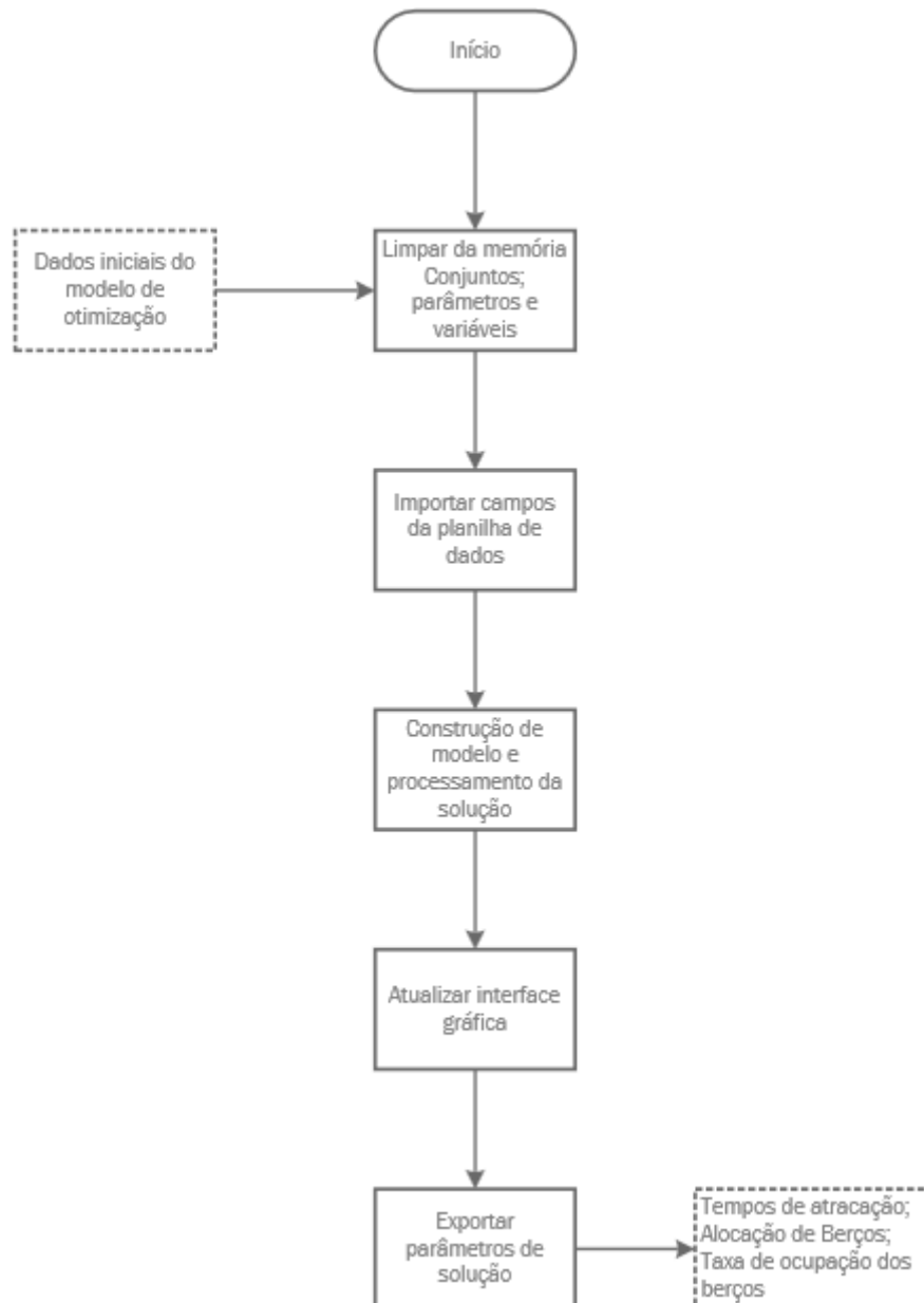
Figura 4.4: Fluxograma de processos da interface em AIMMS
