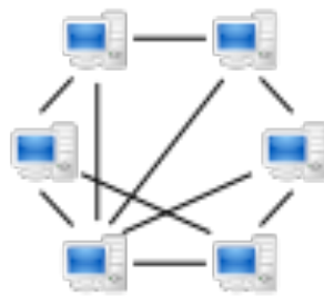
Figura 4 - Sistema P2P sem uma infraestrutura central Fonte: Adaptado de Computer n screen.svg
