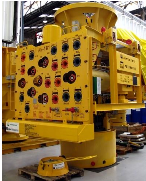
Figura 3.1: Árvore de Natal Molhada (ANM). Fonte Petrobras
