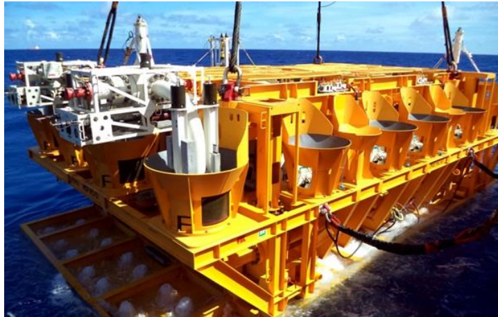
Figura 3.2: Manifold. Fonte Petrobras
