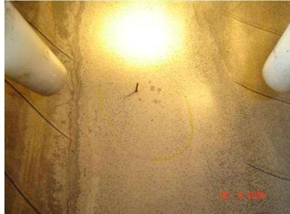
**Figura 29:** Prego localizado dentro do pneu
