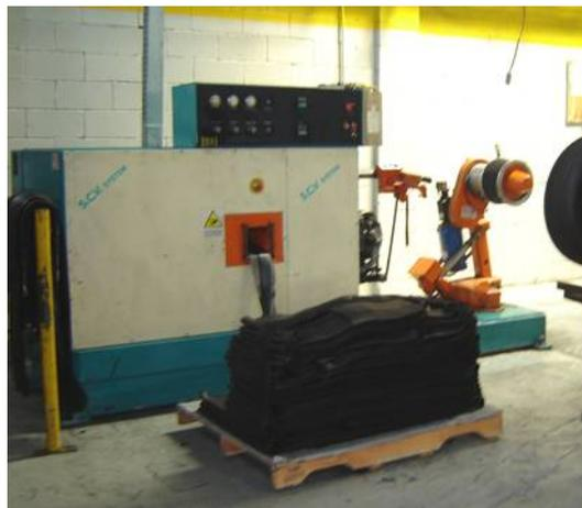
**Figura 75:** Abastecimento de borracha na máquina Orbitread com paletes.
