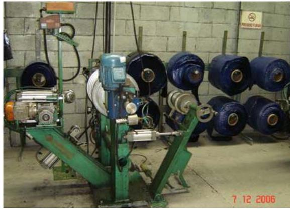
**Figura 36:** Máquina de Cobertura Camelback
