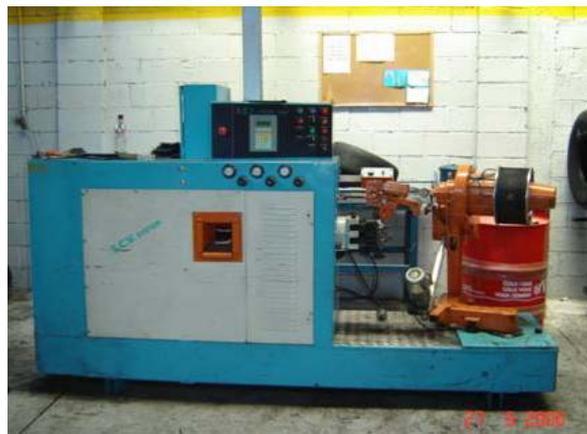
**Figura 35:** Máquina de Cobertura Orbitread
