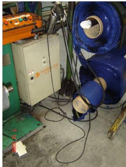
**Figura 38:** Fiação exposta e pedal solto
