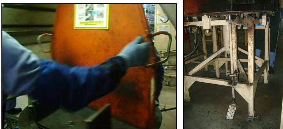
Figura 22: Operador girando a mesa e pedal liberado pelo soldador no outro lado dela.
