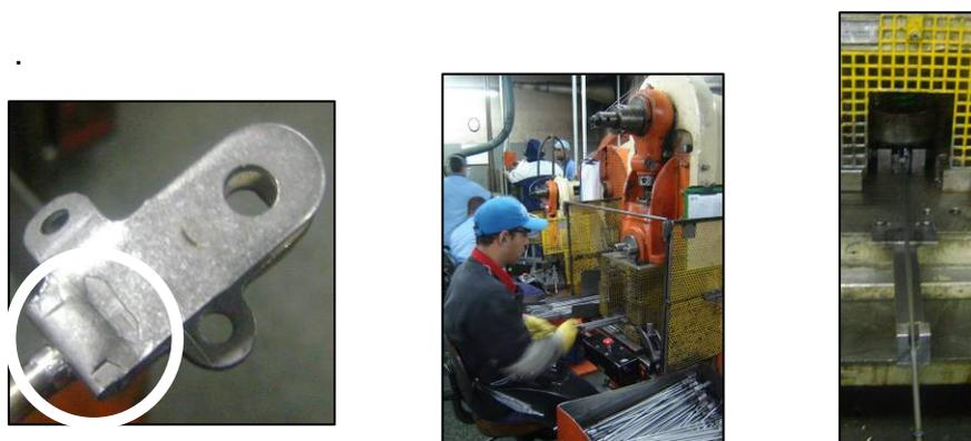
Figura 11: Sétimo processo: À esquerda, detalhe do cravamento. No centro, detalhe do operador na prensa. À direita, um dos apoios criados após a instalação dos controles bimanuais .
