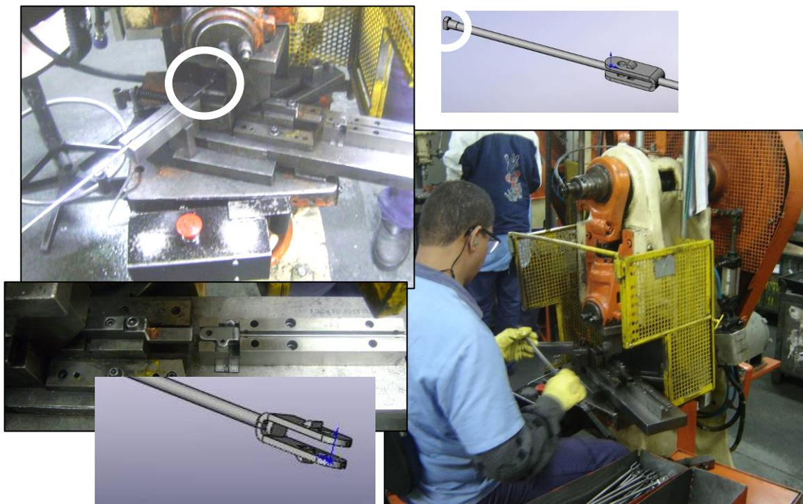
Figura 10: Sexto processo: Esquerda superior, achatamento do anel. Esquerda inferior, cravamento da vareta. À direita, operador colocando articulador na posição para cravamento .
