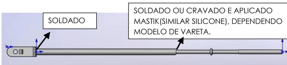
Figura 16: Processos de solda MAG que ocorrem fora da linha de produção das varetas.
