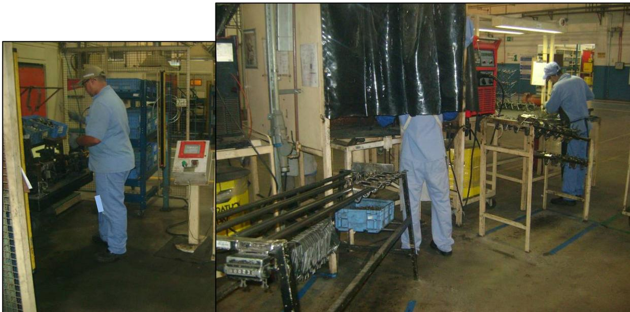
Figura 18: Detalhes da linha automática: Foto esquerda, mesa do robô. Foto direita, detalhe da rampa de passagem, da solda manual e da inspeção.
