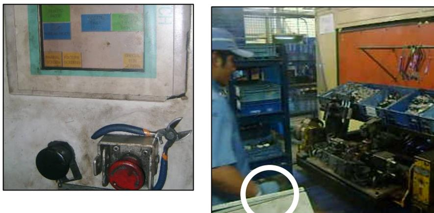
Figura 19: Foto à esquerda, detalhe do painel de comando sensível ao toque (cada quadrado colorido é um comando: azul, verde e amarelo) e botão de acionamento (preto) e emergência (vermelho). Foto à direita, operador acionando o comando com a lateral da mão fechada.
