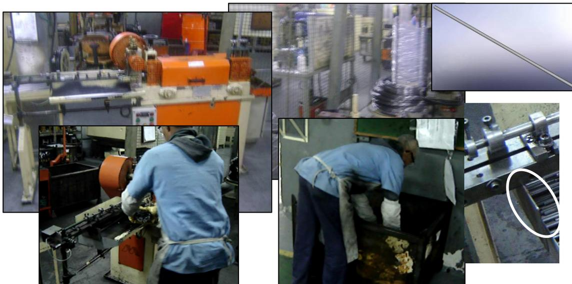
Figura 05: Primeiro processo, formação dos blanks - Desbobinador, endireitador e guilhotina – na parte inferior postura do operador para a retirada dos blanks e colocação em caixas para aguardar utilização no processo. Detalhe da placa que paralisa a máquina se o arame não for cortado.
