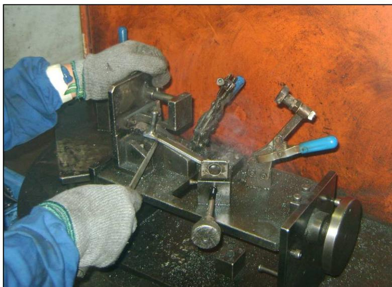
Figura 21: Operador retirando peça com ajuda de uma alavanca devido à dilatação após a solda.
