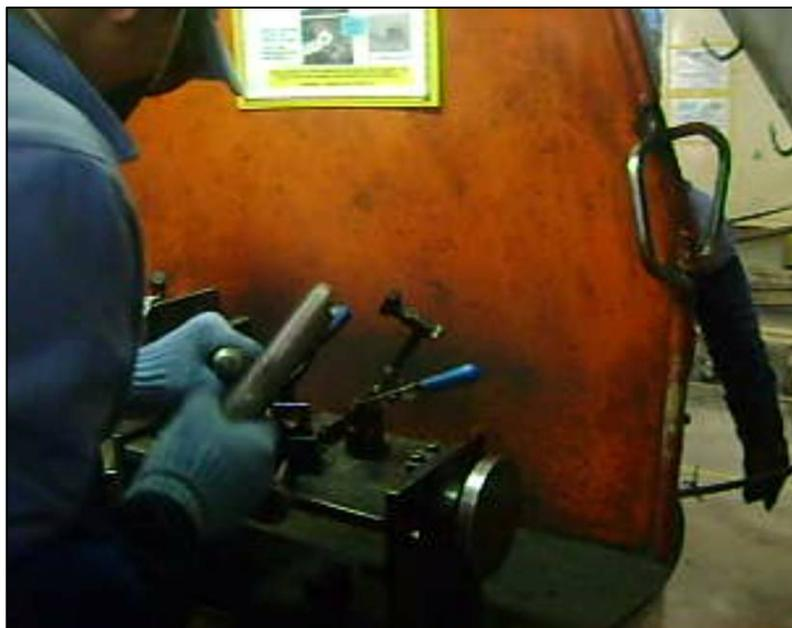
Figura 23: Operador retirando respingos do dispositivo de solda.
