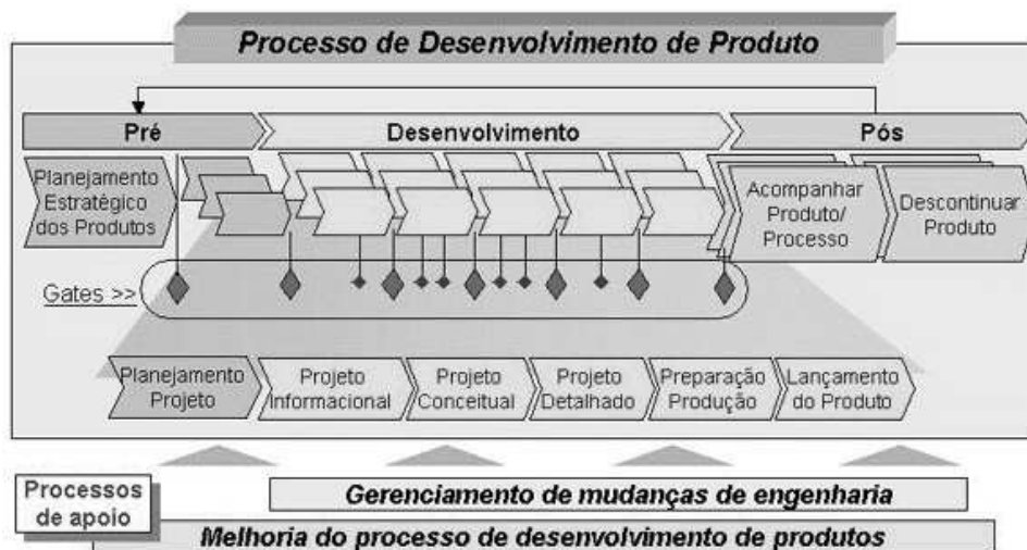
Figura 8 – Modelo do processo de desenvolvimento de produtos (PDP)
