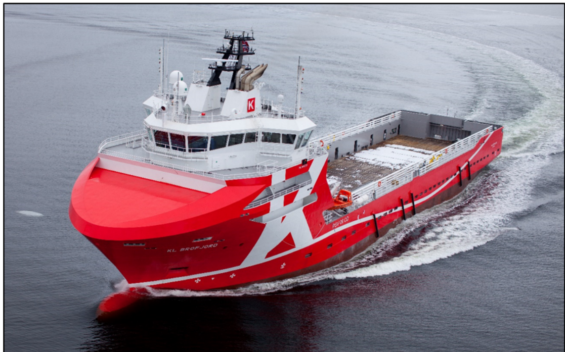
Figura 1.3: Embarcação PSV para operações de suprimento. Fonte: (NET, 2017b)
