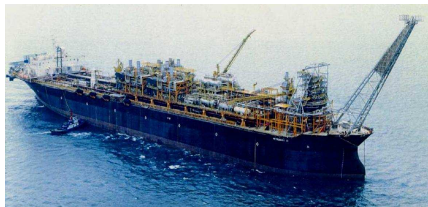
Figura 12. Plataforma FPSO (ARATANHA, 2005).
