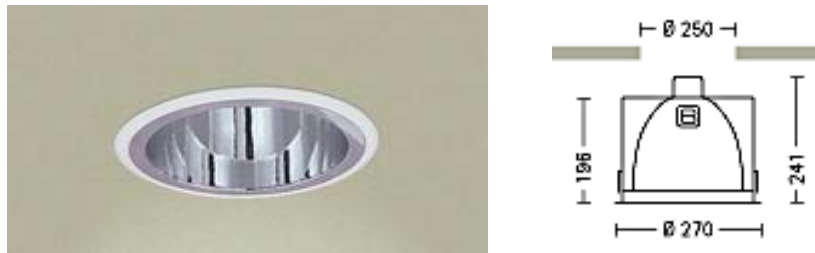
Figura 59 – luminária de fecho fechado para 2 lâmpadas fluorescentes compactas de 32W (LUMINI 4039/232) ou de 42W (LUMINI 4039/242). Esta segunda possui vida mais longa, diminuindo a periodicidade da manutenção.
