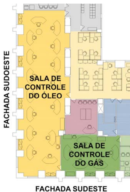
Figura 34 – Planta das salas de controle existentes.
