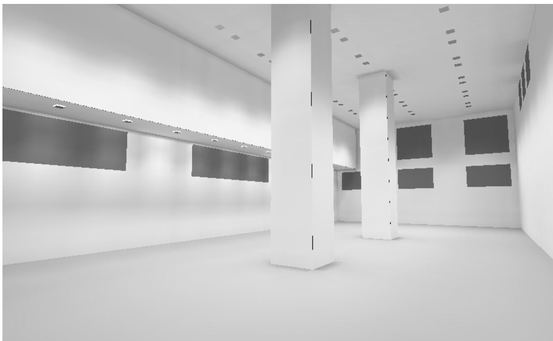
Figura 58 – renderização em Lumen Micro, apresentada pela consultoria em iluminação com a utilização de luminária de facho fechado com lâmpada fluorescente compacta de 32W.
