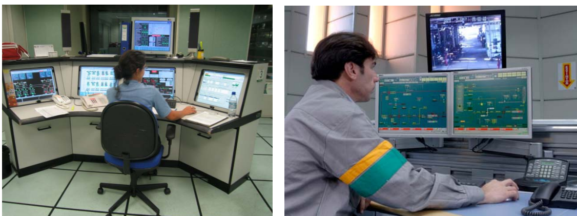
Figura 19 – displays incorporados à estação de trabalho de salas de controle: à esquerda consoles tradicionais com monitores CRT; à direita consoles mais modernos com monitores LCD.
