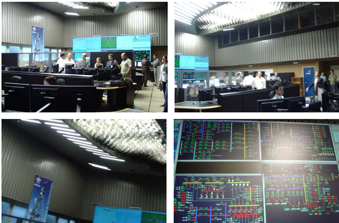
Figura 41 – Iluminação da situação de referência observada: distribuição pouco uniforme das luminâncias nas superfícies; materiais de refletância baixa; fortes sombras nos planos verticais junto ao teto provocadas por luminárias e reflexos no video wall .
