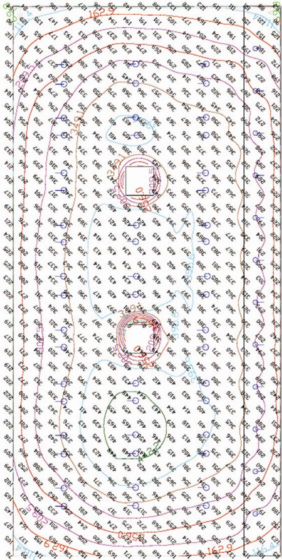
Figura 62 – distribuição das iluminâncias resultante das novas luminárias no plano horizontal de trabalho. (Simulação desenvolvida pela consultoria em iluminação)
