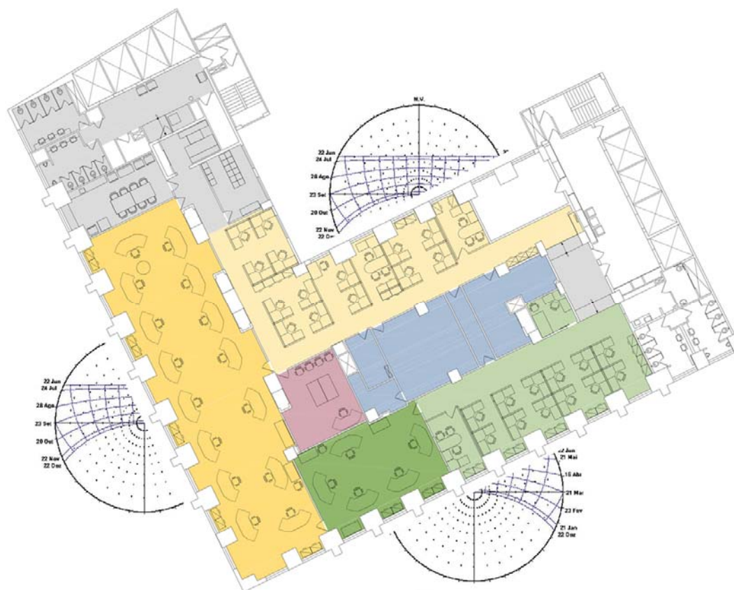
Figura 79 – Insolação das fachadas em relação ao layout existente no 8º pavimento.
