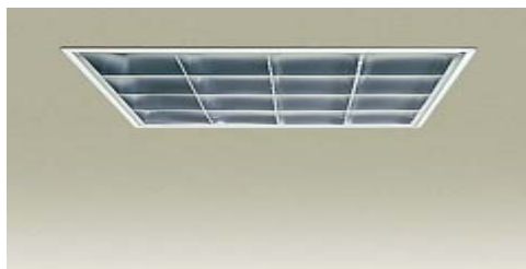
Figura 51 – imagem da luminária utilizada para iluminação geral no estudo preliminar da sala de controle, com aletas parabólicas foscas e duas lâmpadas de 36W (LUMINI FE4594/236) e respectiva curva fotométrica.
