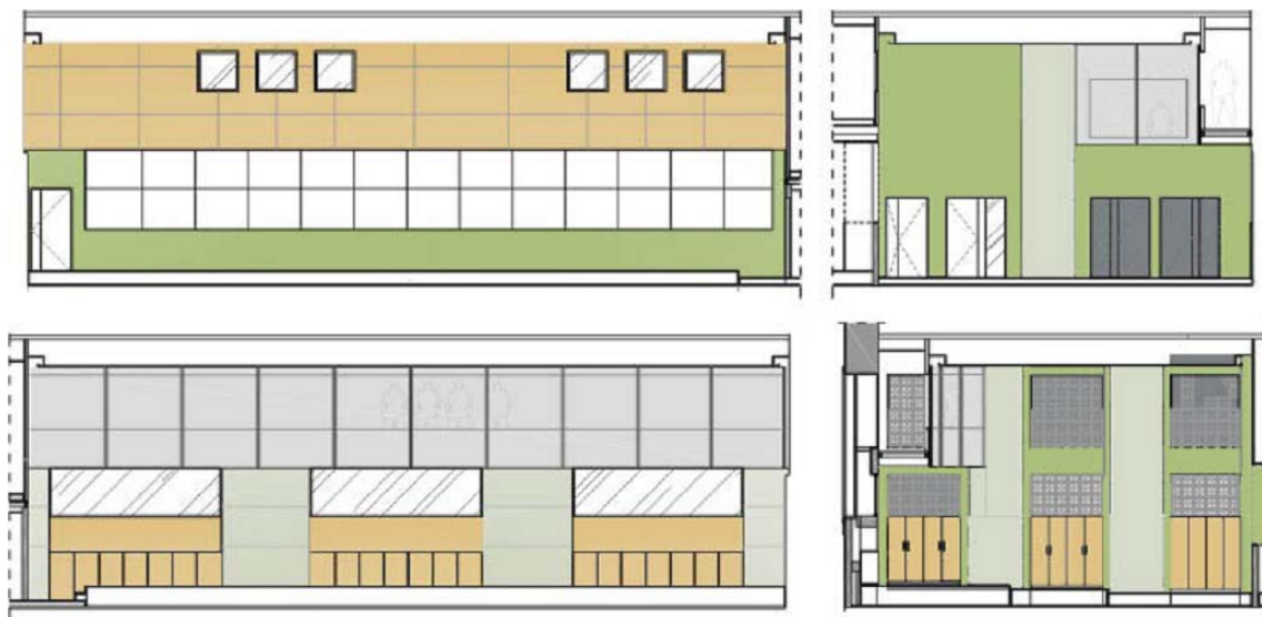
Figura 56 – Vistas interna finais da sala de controle. No canto inferior esquerdo a vista do pele de vidro da passarela.
