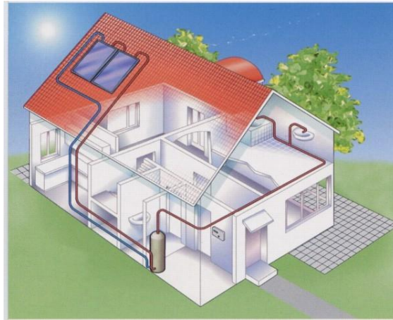
Figura 11 – Residência com aquecimento de água com fonte solar
