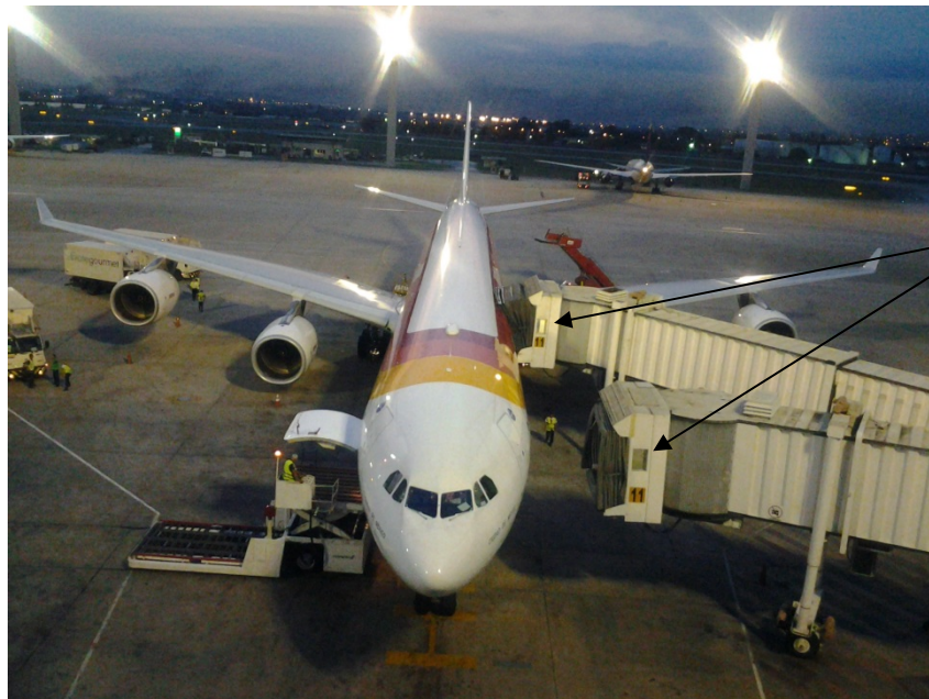
Figura 26. Acoplagem a ponte de número 11. Destaque para a janela no túnel da ponte que permitiu a contagem dos passageiros. Detalhe também para a abertura do bagageiro e a operação de retirada das bagagens sendo executada.
