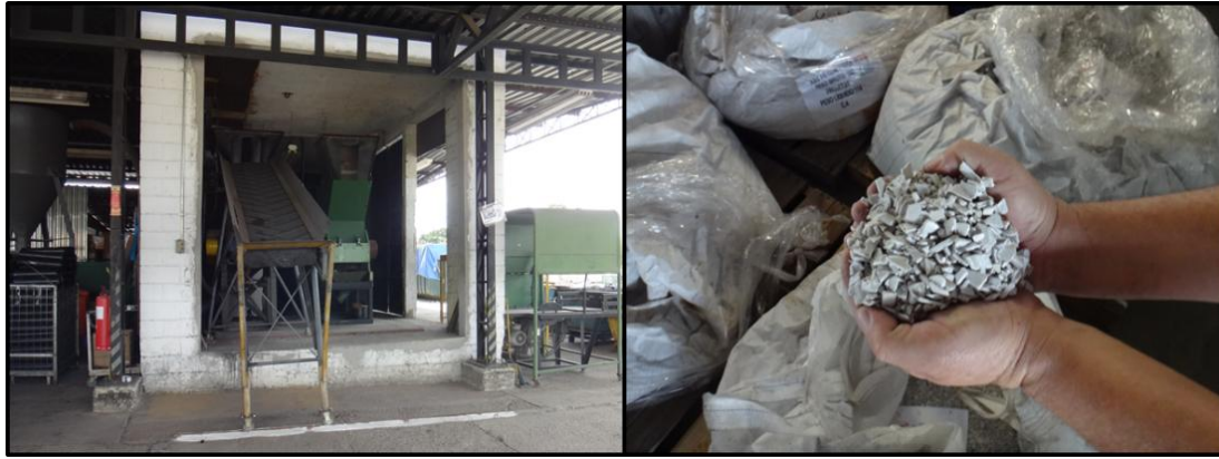
Figura 28 - Triturador de plásticos e plástico triturado
