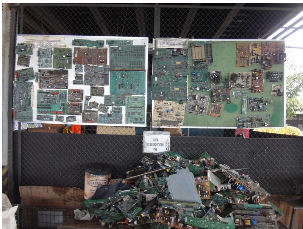
Figura 23 - Área de desmontagem de PWB
