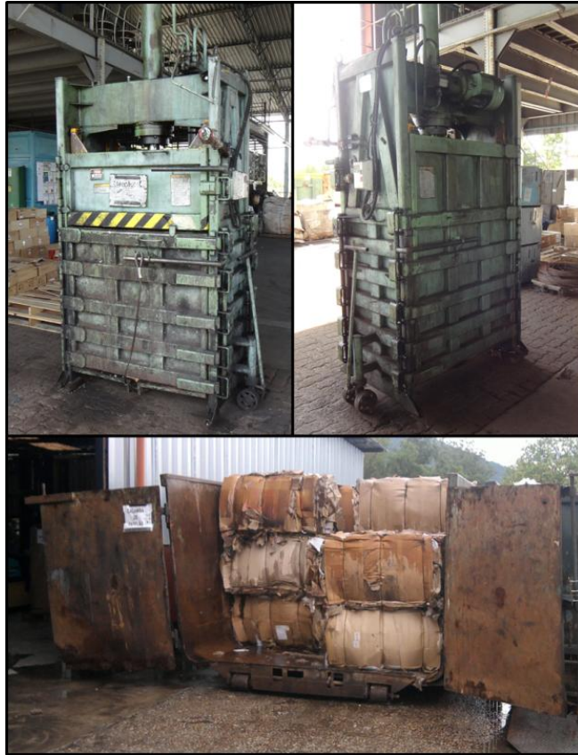
Figura 27 - Prensa de papelão e plástico mole e papelão prensado na caçamba
