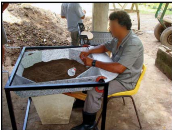
Foto 39 - Posto de trabalho testado por funcionário de estatura de 171 cm
