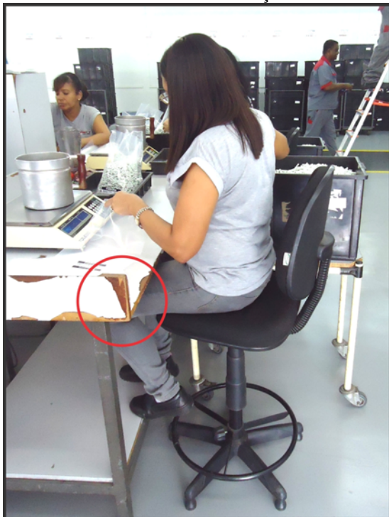
Foto 15 – Mobiliário inadequado, quina viva.
