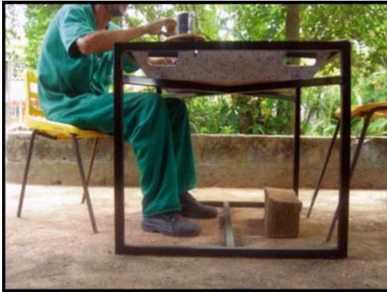
Foto 41 - Posto de trabalho testado por funcionário de estatura de 171 cm
