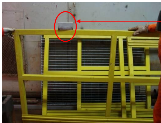
Figura 21 – Guarda corpo fora de especificação recebido por P-F
